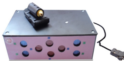
Figura 1.- Dispositivo “Laser Mouse” desarrollado por el Centro para la Rehabilitación Internacional”. Es un dispositivo que consta de 8 orificios que están dispuesto de forma tal que al iluminarlos con un puntero láser producen el movimiento del ratón de manera convencional.
