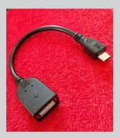
Algunos de los dispositivos presentados a continuación también se pueden conectar a una tablet o celular utilizando un cable adaptador micro USB como el que se muestra en la imagen.
